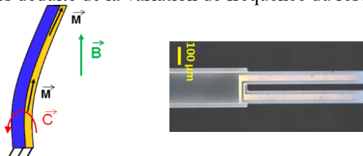
Fig. 1: Branche du diapason en vibration (gauche) et prototype de résonateur en quartz avec une couche mince magnétique en face arrière (droite)
